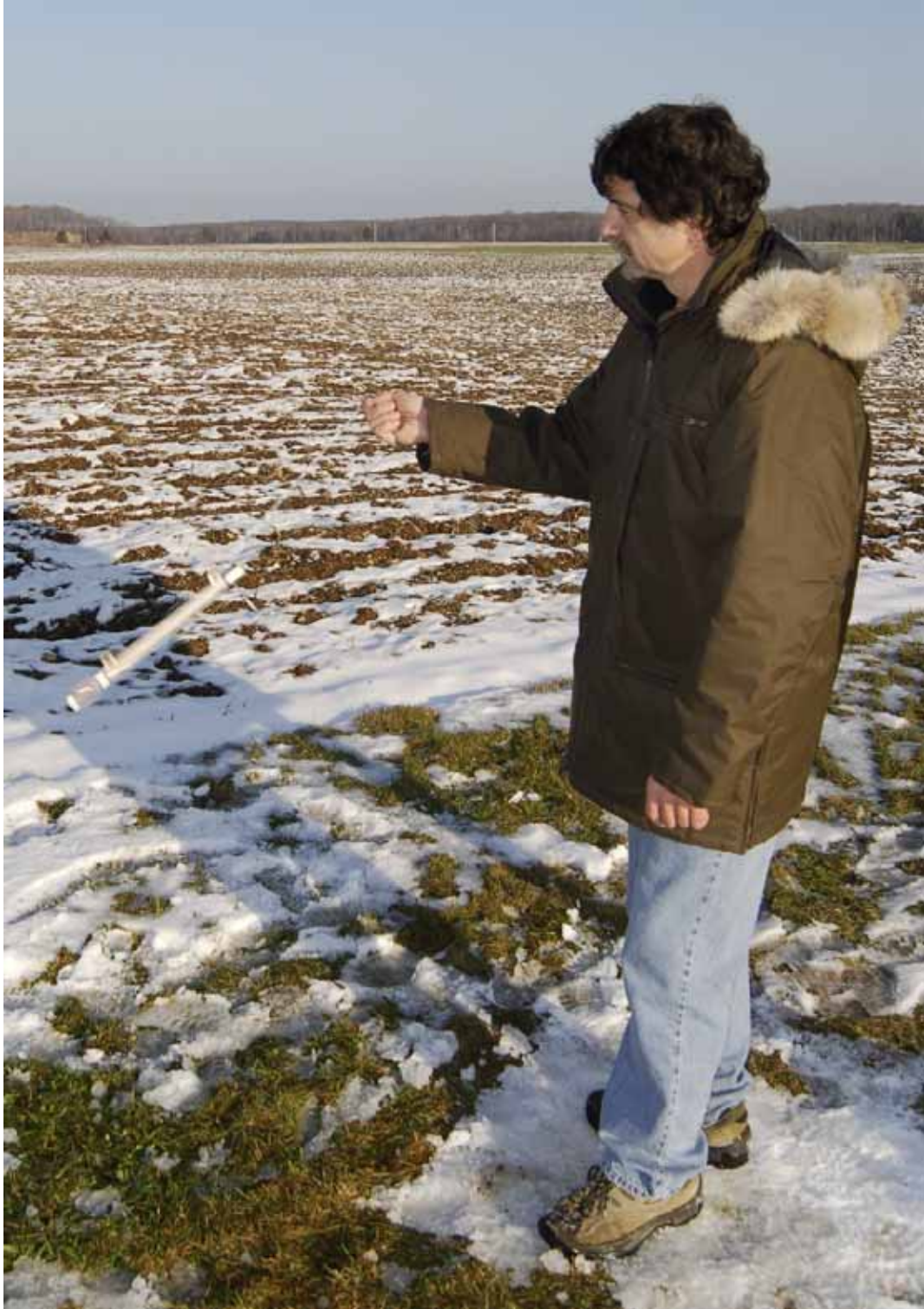
Figure 8.7 Illustration de la deuxième méthode pour réunir la colonne d'alcool dans un thermomètre à minimum
