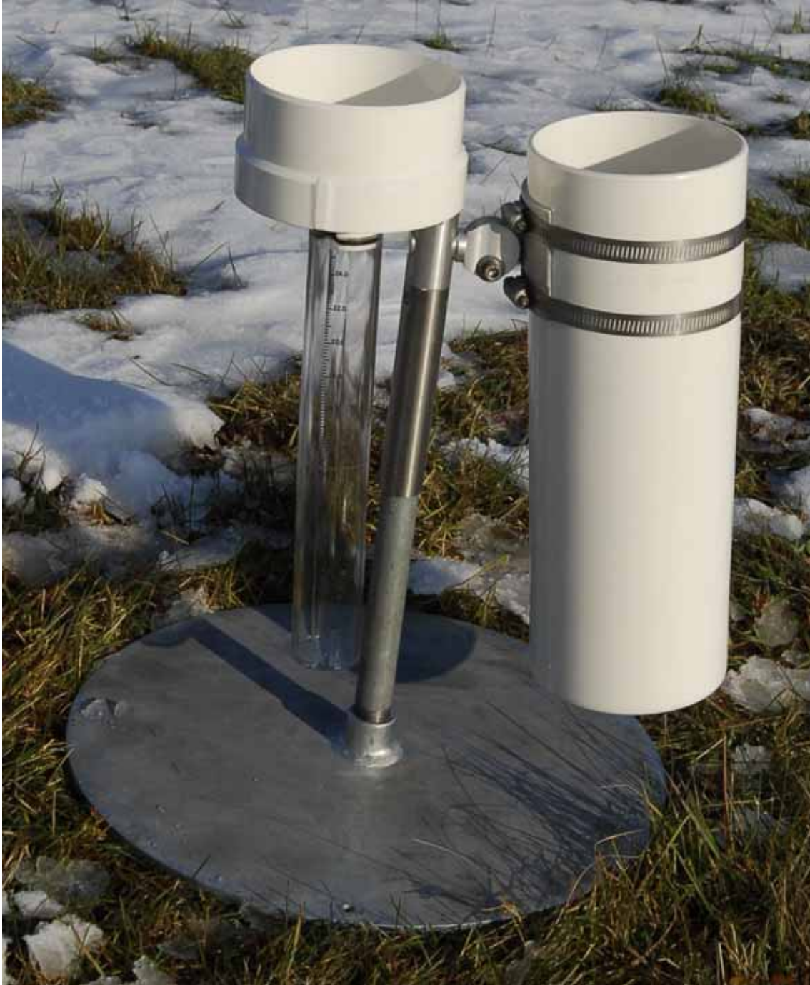
Figure 7.1 Pluviomètre séparé en ses composantes
