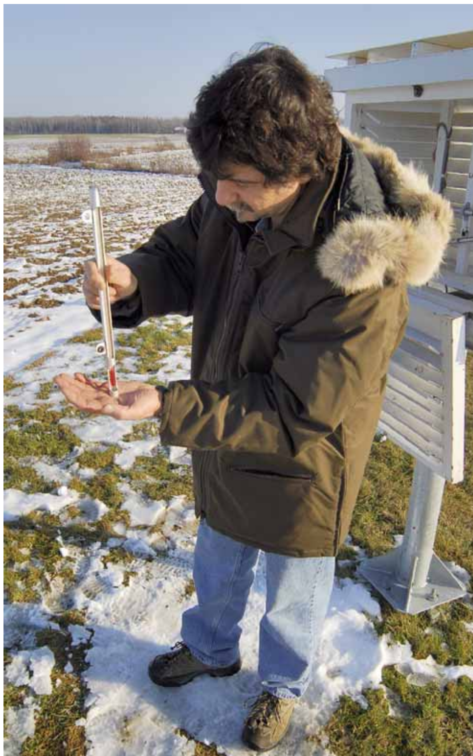
Figure 8.8 Illustration de la troisième méthode pour réunir la colonne d'alcool dans un thermomètre à minimum
